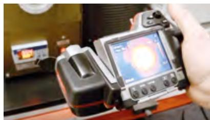
Прибор определяет температуру поверхности ограждающих конструкций – стен, перекрытий, полов, крыш, окон. Оснащенный инфракрасной камерой и видеокамерой, тепловизор
