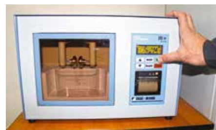
Выставление предельных значений перед испытаниями диэлектрика в установке «СКАТ-М100В»
