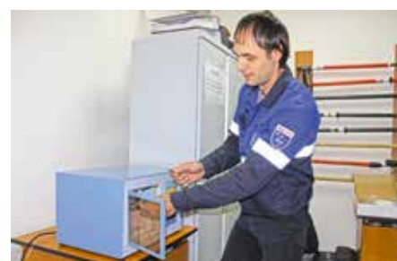
Инженер по метрологии Владимир Шабатура проводит регулировку зазора на пробой
