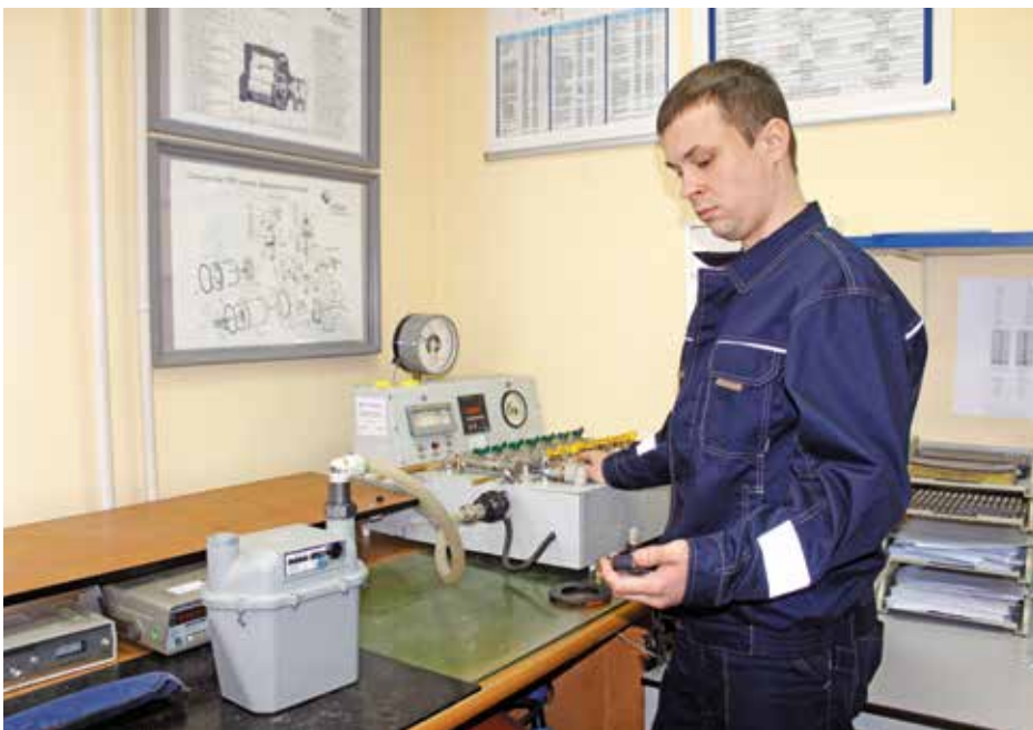
Поверку счетчика газа проводит инженер-метролог Андрей Терехов
