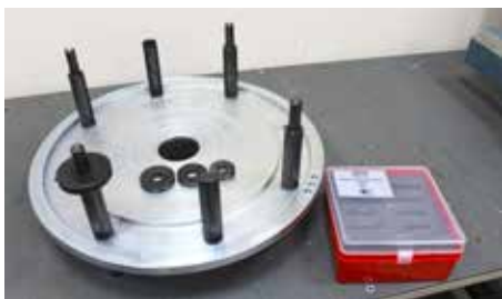
Разработка метрологов Омского ЦСМ: средство поверки стендов для определения массы остаточного дисбаланса колес автотранспорта – набор грузов контрольных
