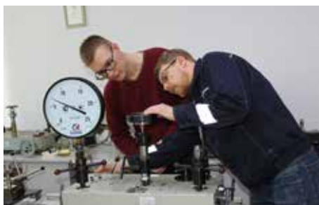
Проверка манометров под руководством С.И. Федорченко
