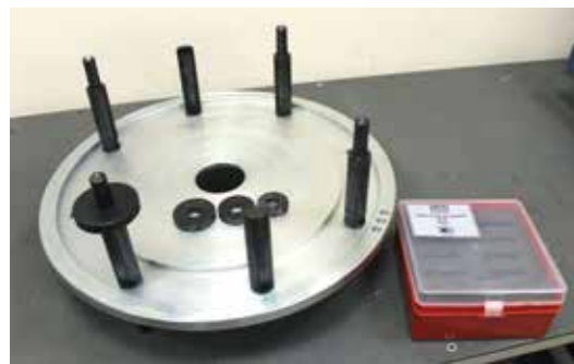
Разработка метрологов Омского ЦСМ: набор грузов контрольных (рег. № 88560-23 в ФИФ по ОЕИ)
