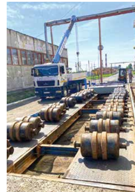
Метрологи Омского ЦСМ проводят поверку автомобильных весов на Лузинском комбикормовом заводе
