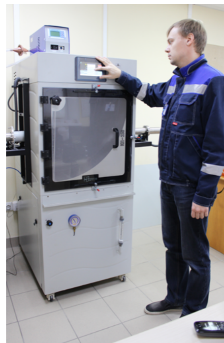
С камерой пыли работает инженер-метролог Дмитрий Воробьев
