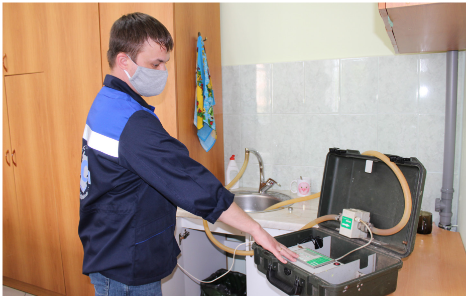
Инженер по метрологии А.С. Терехов проводит поверку водосчетчика
