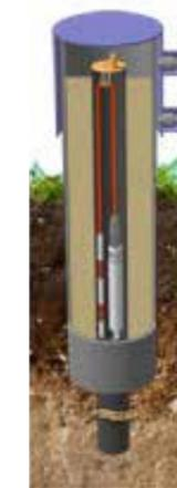
Измерения температуры в грунтах вечной мерзлоты
