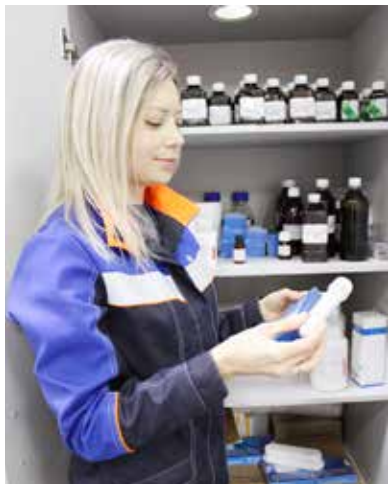
Инженер по метрологии 2 кат. Наталья Коробичина готовит стандартные образцы для поверки анализатора размера частиц
