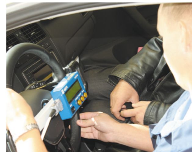
Специалист Омского ЦСМ проводит измерение суммарного люфта рулевого управления
