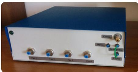
Генераторы газовых смесей УФПГС-4 являются рабочими эталонами 1-го разряда в соответствии с ГОСТ 8.578-2008 и предназначены для воспроизведения значений объемной доли компонентов в бинарных газовых смесях ( $O_2$ ,  $H_2$ ,  $CO$ ,  $CO_2$ ,  $Ar$ ,  $He$ ,  $N_2$ ,  $N_2O$ ,  $CH_4$ ,  $C_2H_2$ ,  $C_2H_4$ ,  $C_2H_6$ ,  $C_3H_8$ ,  $C_4H_{10}$ ,  $C_5H_{12}$ ,  $C_6H_6$ ,  $C_6H_{14}$ ) в воздухе и азоте.
