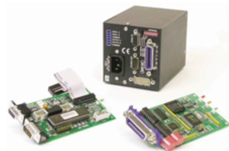
Рисунок 2. Контроллеры управления по IEEE488 и RS232: встроенный интерфейс и внешний модуль
