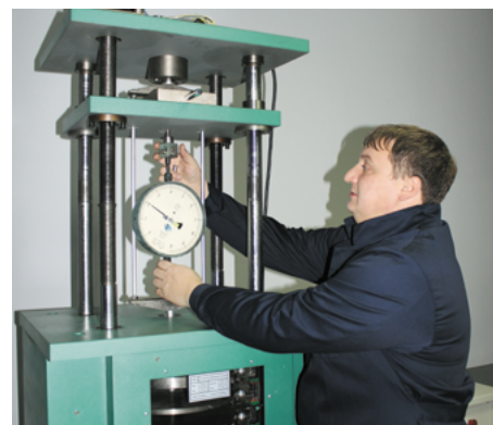
Инженер по метрологии Дмитрий Шестаков проводит поверку динамометра на СПНМ-1
