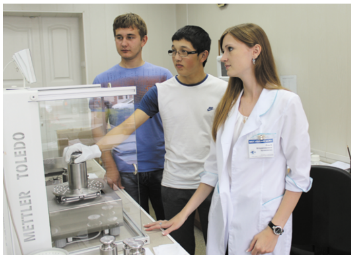
При участии инженера по метрологии О.В. Бронниковой студенты поверяют гири КТ E_2
