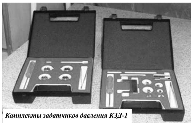
«Омский ЦСМ» можно проводить поверку высокоточных калибраторов давления с погрешностью  $\pm 0,01\%$  в диапазоне от -0,1 до 7 МПа.
