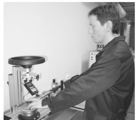
*Инженер-метролог отдела поверки и калибровки СИ механических величин В.В. Шкловчик поверяет моментный ключ*
