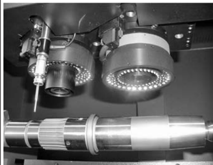
Измерение вала несколькими датчиками
