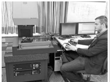
В выставочном зале НПФ «Уран» – измерение детали на КИМ Werth VideoCheck IP 400
