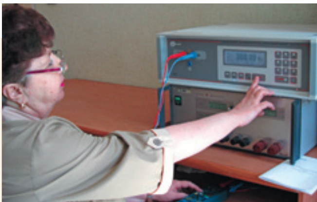
На снимке: проверка измерителя параметров электроизоляции «МИС» на КАЛИБРАТОРЕ ЭЛЕКТРИЧЕСКОГО СОПРОТИВЛЕНИЯ КС-100KST.
