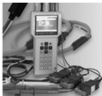
Прибор «Энерготестер ПКЭ» с клещами 10 А и 3000 А
