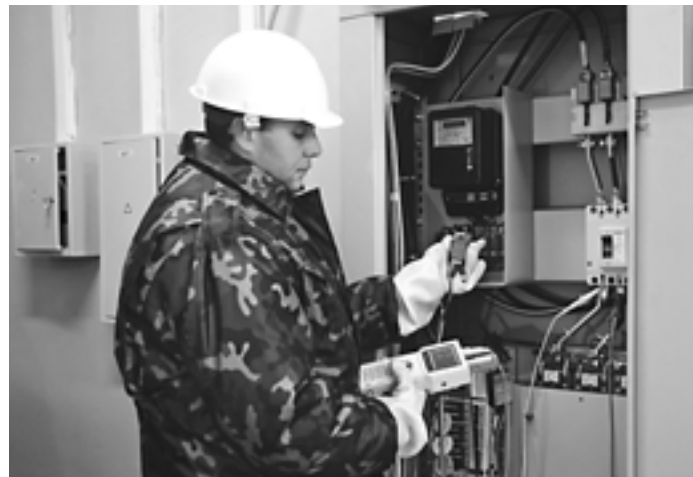
Инженер НПП «Марс-Энерго» в ходе энергоаудита проверяет узел учета с помощью прибора «Энерготестер ПКЭ»
