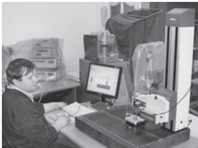
**ПРОФИЛОГРАФ XCR 20** фирмы *Mahr* (Германия), приобретенный отделом поверки и калибровки СИ геометрических величин, – новая, высокоточная установка для оценки контуров и шероховатости. Это прибор высшего класса, со встроенной лазер-
