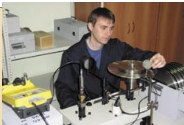
Подготовка к эксплуатации первых рабочих эталонов давления – грузопоршневых манометров
