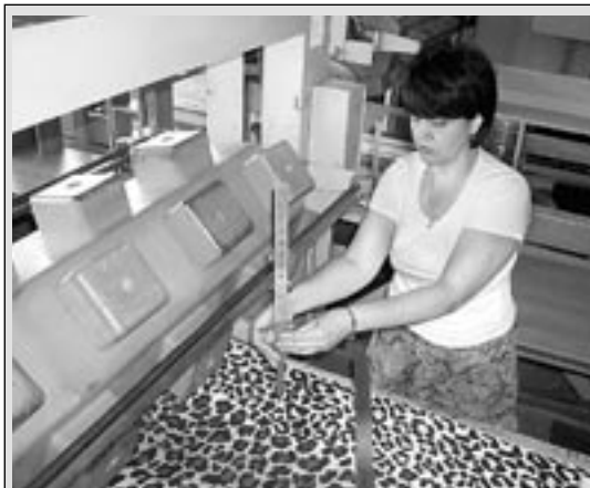
Инженер-технолог испытательной лаборатории ОС «Сертификат-Сервис» С.Л.МАЛИЙ проводит стендовые испытания на долговечность пружинного матраца, изготовленного ИП Пестриковым.
