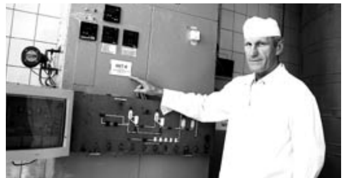
Начальник консервного цеха Н.М.Микенин демонстрирует ККТ №8 (контроль температуры пастеризации) — основную при производстве сгущенного молока.
