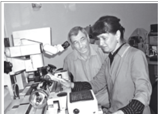
Э.И.Смолягин и начальник испытательной лаборатории СИ геометрических величин Т.П.Константинова проводят измерение резьбового калибра на микроскопе УИМ-23.
