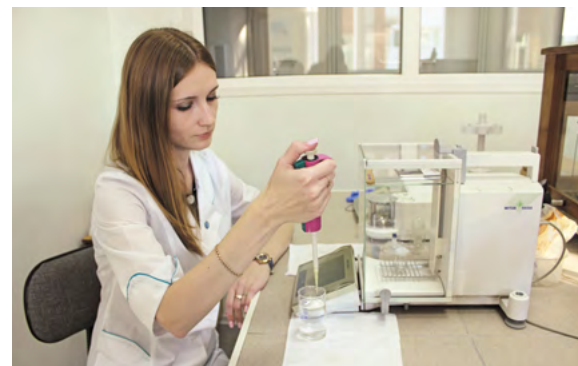
Инженер-метролог Ольга Бронникова проводит поверку медицинского дозатора
