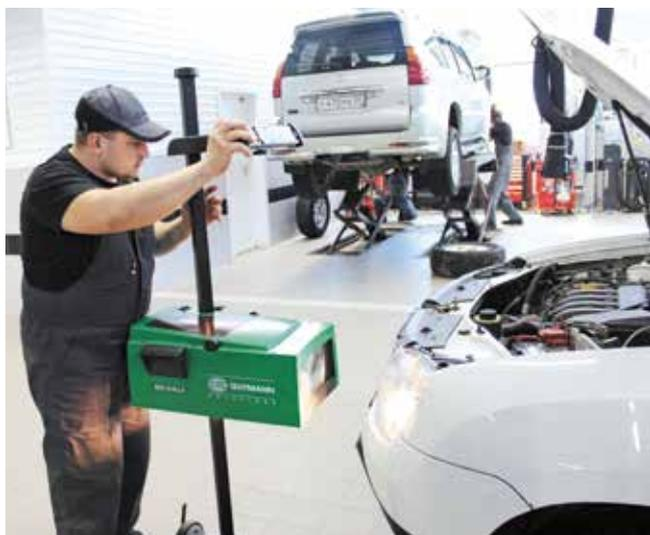
Измерение параметров света фар автомобиля на СТО
