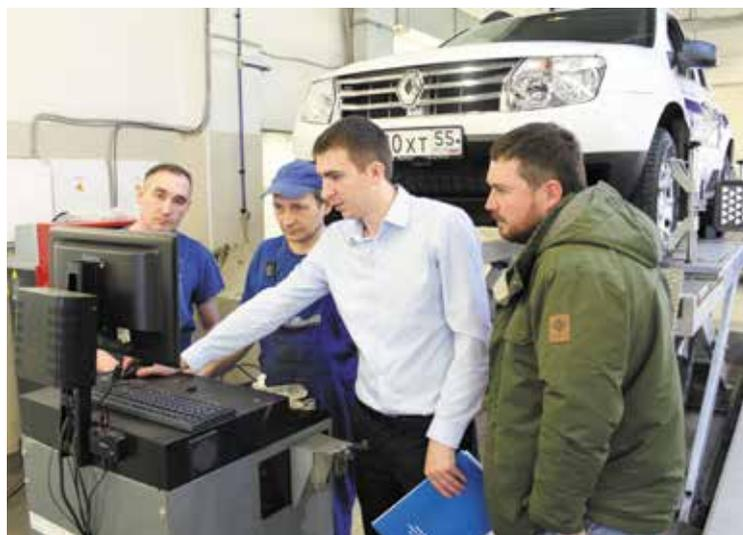
Измерение углов установки колес (развал-схождение)
