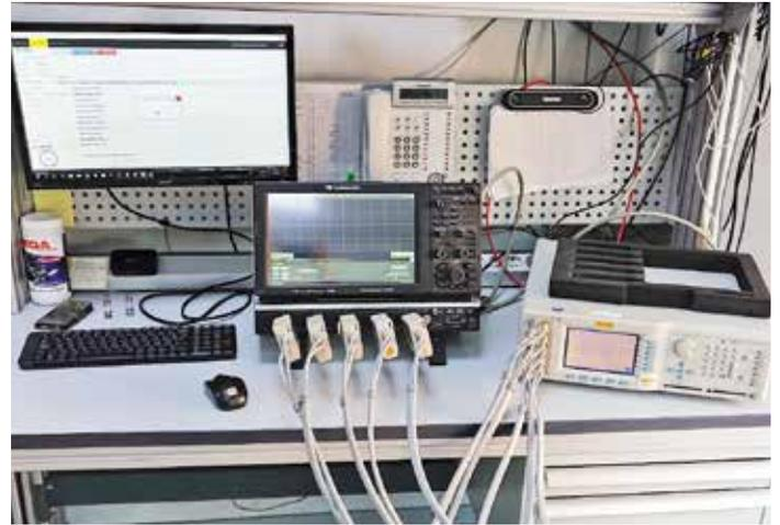
Фото 2. Осциллограф Teledyne LeCroy поверяется при помощи автоматической процедуры, написанной специалистами АО «ПриСТ» для калибратора осциллографов FLUKE 9500B
