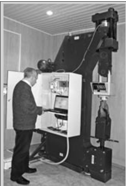
Инженер по метрологии I категории В.Е.Купцов поверяет 10-тонные крановые весы Омского завода металлоконструкций.
