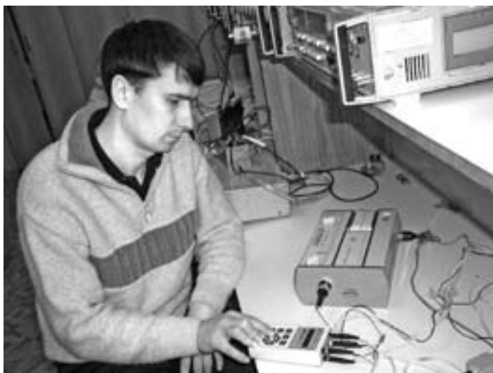
НА СНИМКЕ: ведущий инженер отдела поверки и калибровки СИ радиотехнических величин и ионизирующего излучения Д.В.Либуркин – за работой на приборе «Диатест», с помощью которого осуществляется поверка электрокардиографов.
