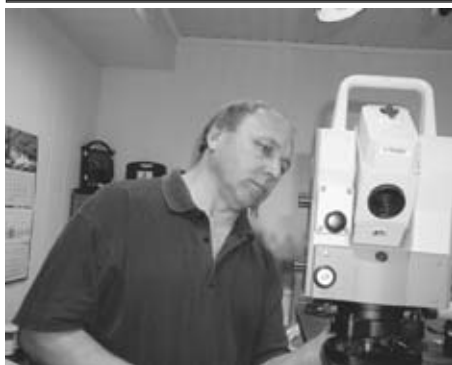
На снимке: ведущий инженер А.Н.ЦЫГАНОК определяет метрологические характеристики тахеометра.
